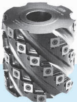
Cabezales helicoidales con insertos de 4 filos de alta exportación de cepillado en aluminio aluvional o acero de alta tenacidad.
